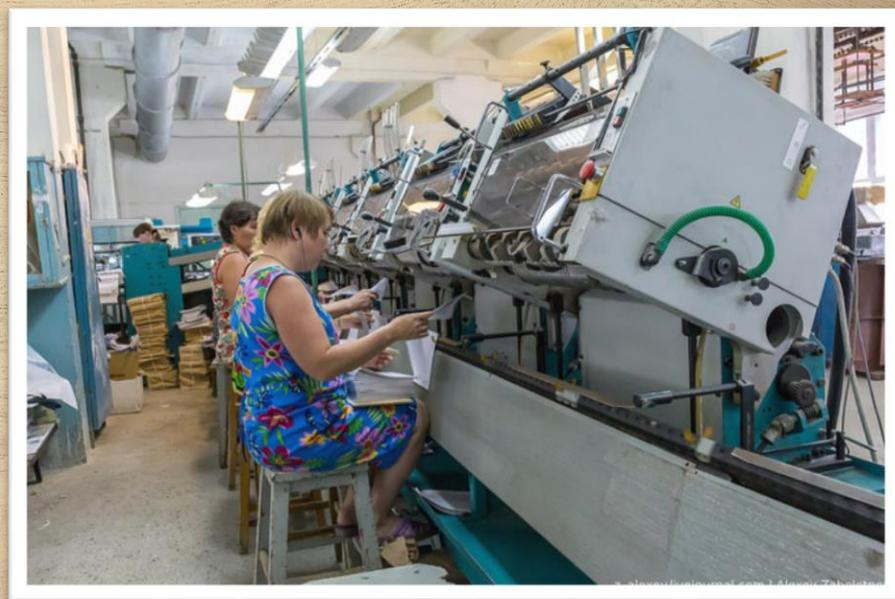
*Некоторые идут на скрепление обычной скрепкой. Девушки вручную «насаживают» тетради на станок.*
